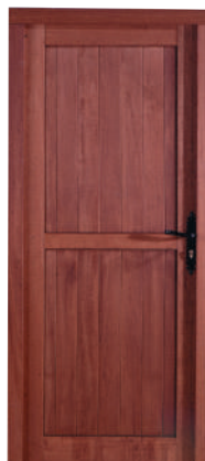
Modèle exotique. Cadre 32 mm , remplissage frises verticales pas de 27 mm , ferrage par paumelles, poignée fournie, option serrure 3 points encastrée.
