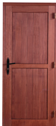
Modèle exotique. Cadre 32 mm , remplissage frises verticales pas de 27 mm , ferrage par paumelles, poignée fournie, option serrure 3 points encastrée.
