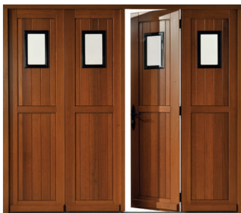
Modèle exotique, cadre de 32 mm , remplissage frises verticales pas de 27 mm , bâti de 65 x 55 mm avec option serrure 3 points et hublot PVC
